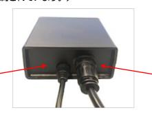
モーターケーブルプラグ(メス)を大きな丸いコネクタに挿入し、ノッチを回して押し、しっかりとねじ込みます。電源ソケットをオンにします。 四角いソケットの間の LED ランプが緑色に点滅してから赤色に点灯します。
